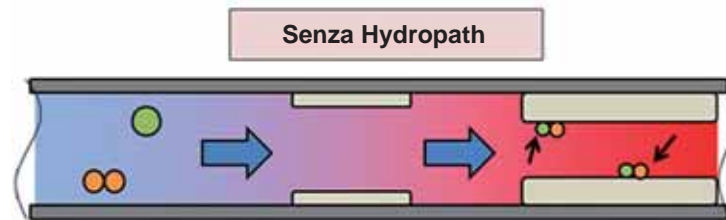
Fig 10: Il calcare si forma sulla superficie del tubo e quando l'acqua viene riscaldata, gli ioni cristallizzano sulla superficie del tubo che è l'unico punto di nucleazione . Qualsiasi ulteriore cristallizzazione andrà ad accrescere lo strato interno
