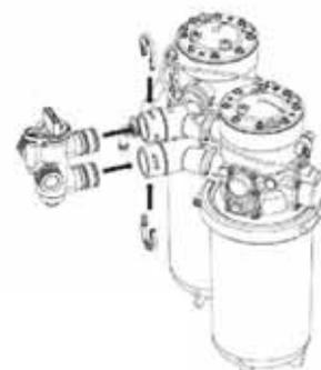
Installazione BYPASS nel modello DUPLEX (optional)
