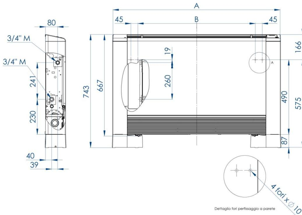
Dettaglio fori per fissaggio a parete
