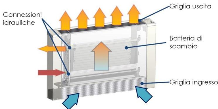
In inverno l'apparecchio aspira dalla griglia frontale l'aria fredda e la convoglia in maniera silenziosa, mediante un ventilatore tangenziale asimmetrico accoppiato a un motore DC Inverter, attraverso una batteria di scambio termico. Compito della batteria è di trasferire il calore proveniente dal circuito idraulico all'aria, riscaldandola. L'aria riscaldata viene immessa nell'ambiente attraverso la griglia superiore.
