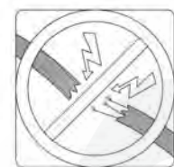
Controllare i cavi danneggiati
