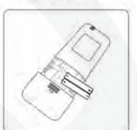
Sostituire le batterie
