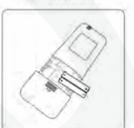
Sostituire le batterie
