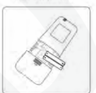
Sostituire le batterie
