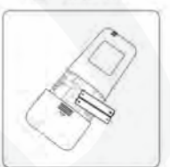
Sostituire le batterie
