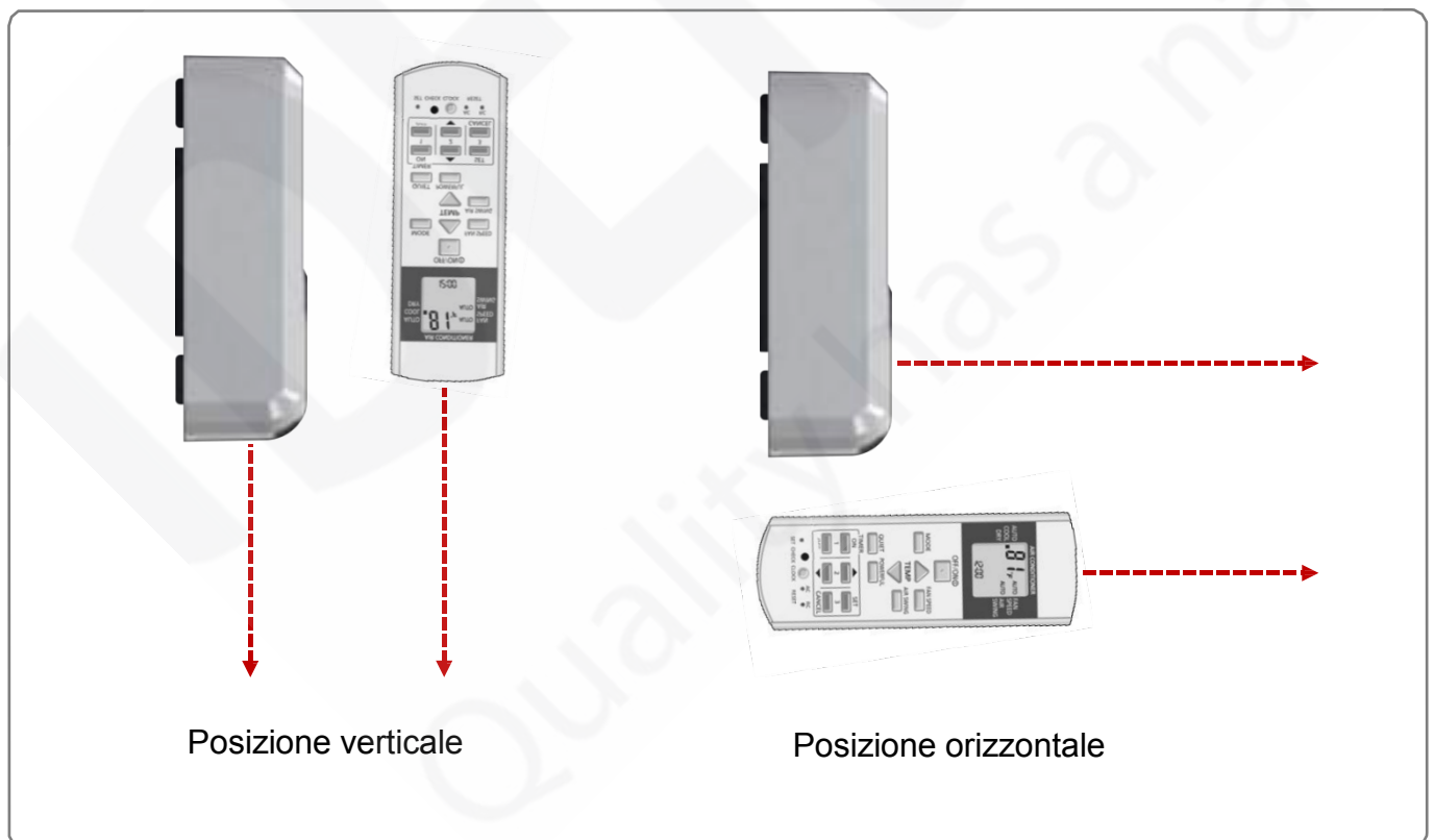
Figure 4-9 Posizioni telecomando per emulare la trasmissione del dispositivo IR
